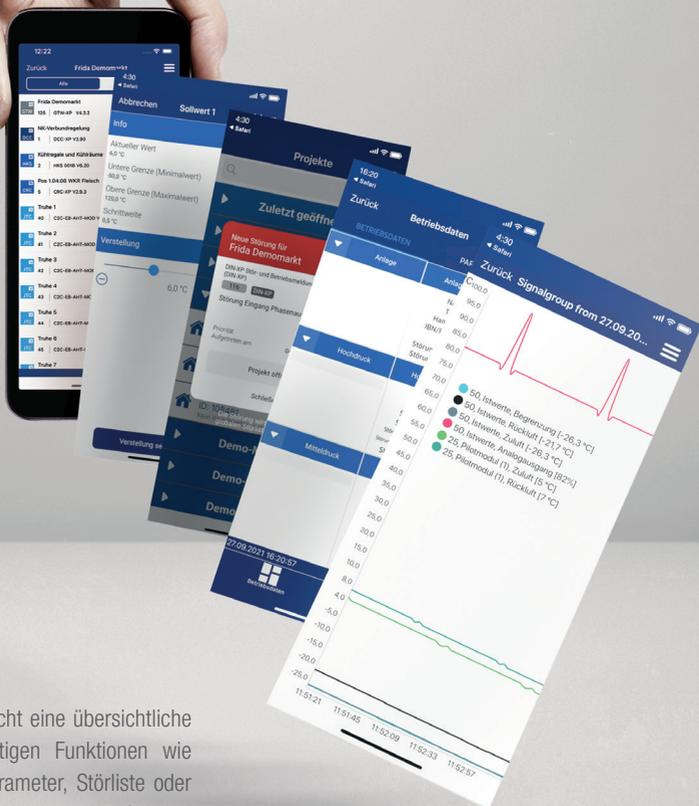
Die FRIDA-App ermöglicht eine übersichtliche Darstellung aller wichtigen Funktionen wie Betriebsdaten, Regelparameter, Störliste oder Oszilloskop. Sollwerte können komfortabel direkt eingestellt werden.
